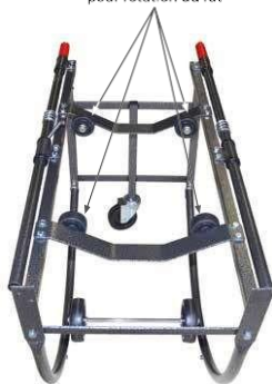
Quatre galets pour rotation du fût
